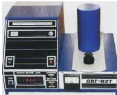
Рисунок 4.5 – Комплекс для индивидуального дозиметрического контроля ДВГ - 02Т с термолюминесцентными дозиметрами.
